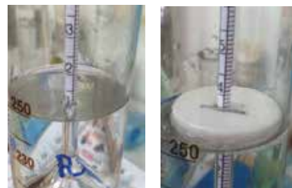
Рисунок 1. Определение плотности сортировки по мениску ареометра (слева) и по фотографии плавающего визира (справа)
